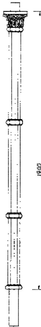
THK-670-K Kandelaber-Oberteil mit Zopf \varnothing 60 mm oder Flanschanschluss Gewicht: ca. 65 kg
